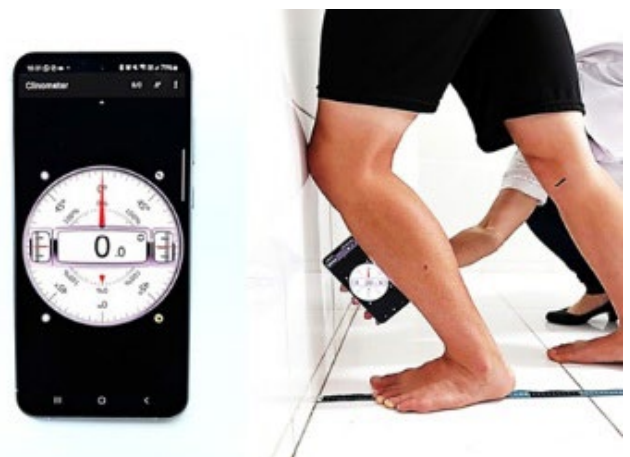
Figura 1. Aplicativo Clinometer (Plaincode, Alemanha) exibido em um smartphone Samsung A55 (esquerda) e posicionado na crista tibial anterior durante o teste de avanço com descarga de peso (direita)
