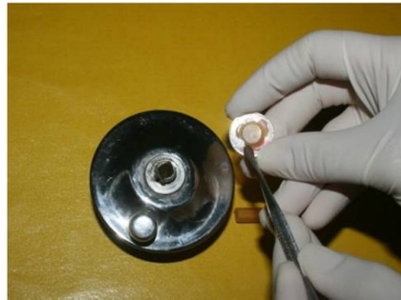
Figura 3. fixação no disco com cera pegajosa
